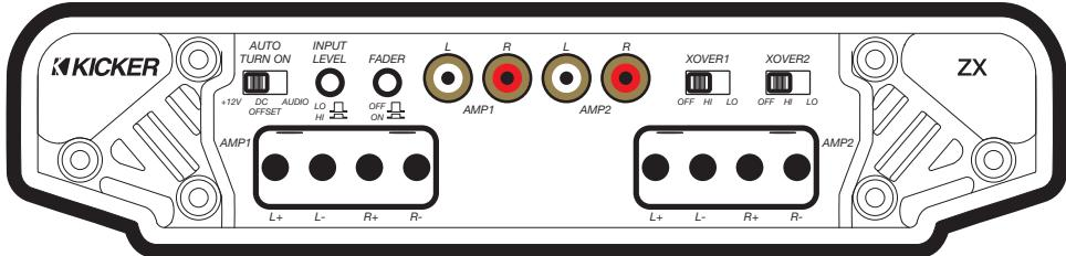
**Регулятор Automatic Turn-On:** Усилители серии ZXМ позволяют воспользоваться тремя режимами автоматического включения, которые можно выбрать на задней панели: +12V, DC Offset и Audio. При выборе режима DC Offset или Audio через разъем REM будет подаваться выходной сигнал +12 В для включения дополнительных усилителей.
