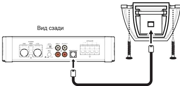
Подключите входящий в комплект кабель к контроллеру KXRC и разъему Remote Bass на панели усилителя.
