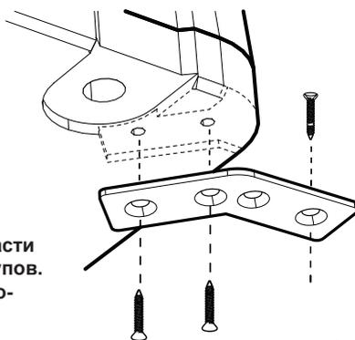
**Монтаж кронштейна:** Закрепите кронштейн к нижней части корпуса с помощью входящих в комплект мелких шурупов. Надежно закрепите корпус к панели автомобиля с помощью входящих в комплект более крупных шурупов.
