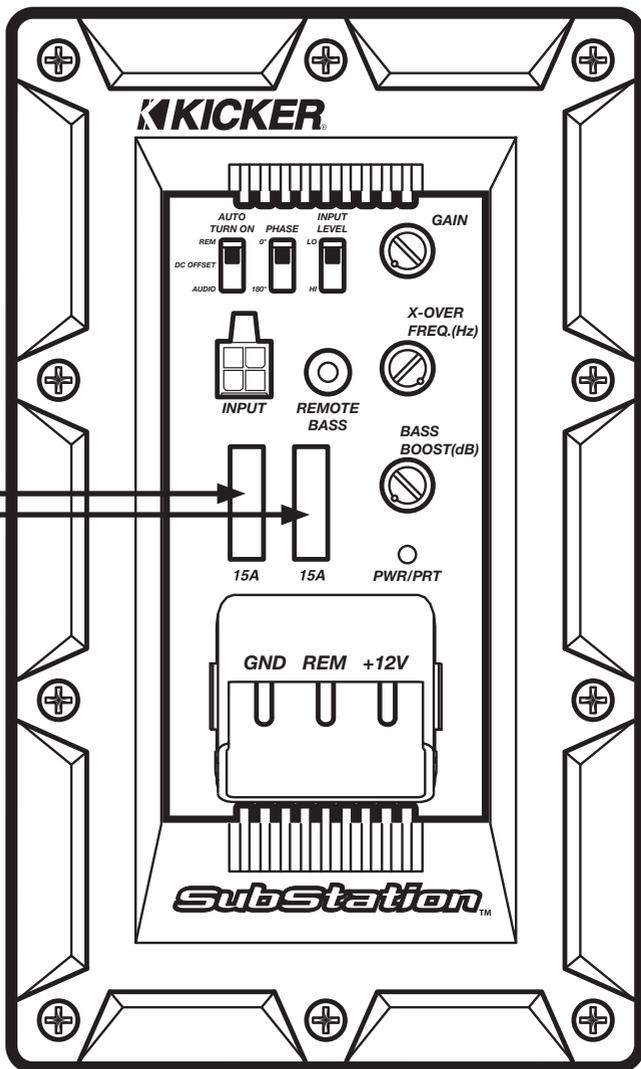
**Регулятор Automatic Turn-On:** Активные корпусные сабвуферы KICKER позволяют воспользоваться тремя режимами автоматического включения, которые можно выбрать на боковой панели: +12V, DC Offset и Audio. При выборе режима DC Offset или Audio через разъем REM будет подаваться выходной сигнал +12 В для включения дополнительных усилителей.
