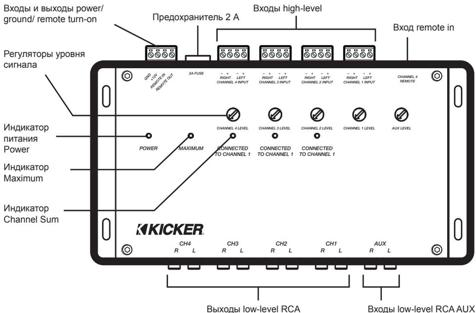
**Поток сигнала Channel 3:** В случае отсутствия сигнала на входе Channel 4, сигнал, принимаемый на входе Channel 3, будет автоматически маршрутизироваться на выходы Channel 3 и Channel 4.
