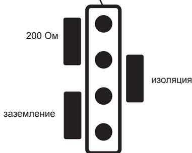
В случае возникновения шумов после установки ZXSUM8, попробуйте изменить положение перемычки заземления и выбрать положение с наименьшим количеством шумов.
